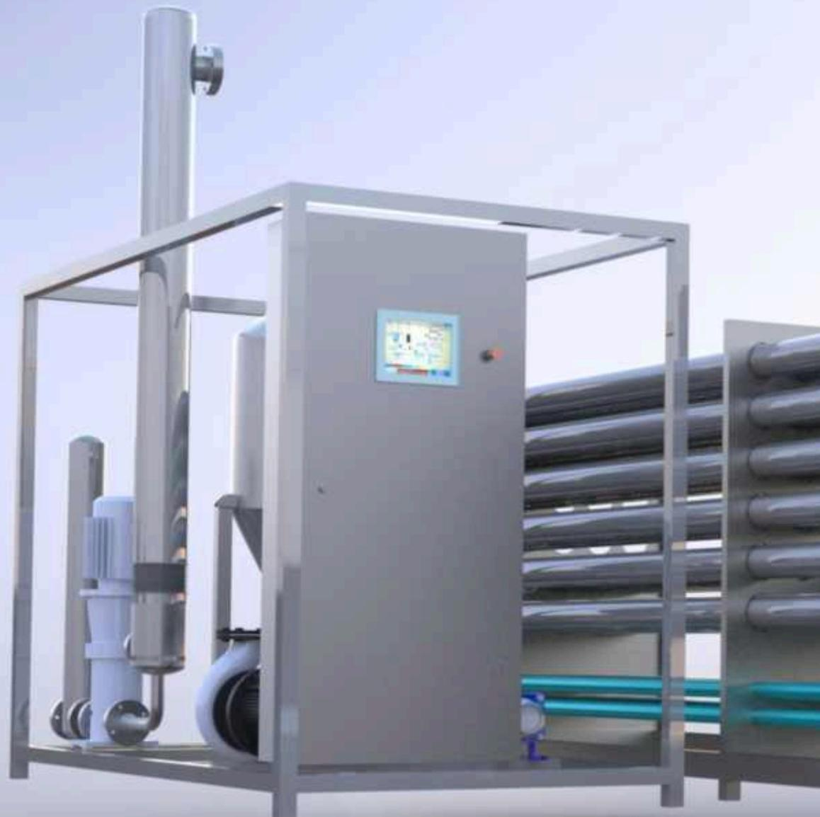
Normalement, les usines UHT indirectes sont directement connectées aux lignes d'emballage. Pour cela, elles sont fournies avec des sections séparées de chauffage pour éviter les sur-traitements du produit si une machine d'emballage s'arrête.
